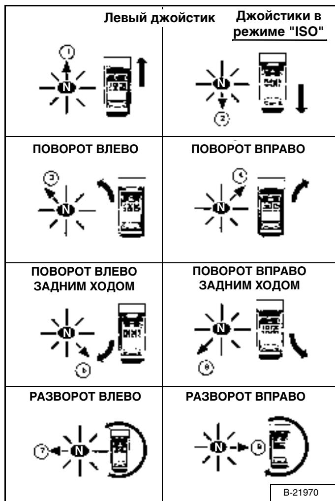
Функции левого джойстика (движение и маневрирование) [Рис. 29]
