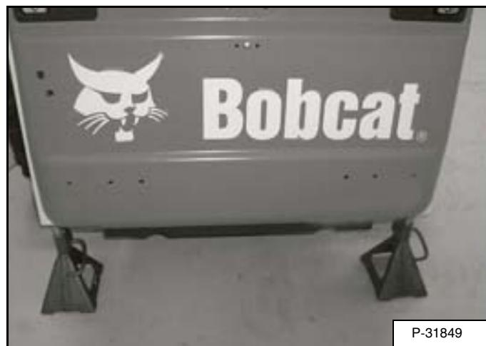
Установите подставки-опоры под задней частью рамы погрузчика [Рис. 142].
