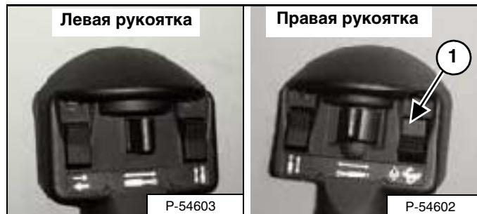
Когда индикатор (1) перестанет мигать, нажмите на нижнюю часть двухпозиционного переключателя скоростей (1) [Рис. 80], чтобы вернуться в односкоростной режим [Рис. 79]. Затем нажмите на верхнюю часть переключателя (1) [Рис. 80] для включения двухскоростного режима.
