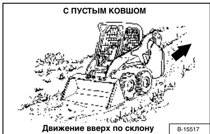
Подъем на склон и спуск со склона с пустым ковшом следует выполнять так, чтобы тяжелая сторона была направлена к вершине склона [Рис. 107] и [Рис. 108].
