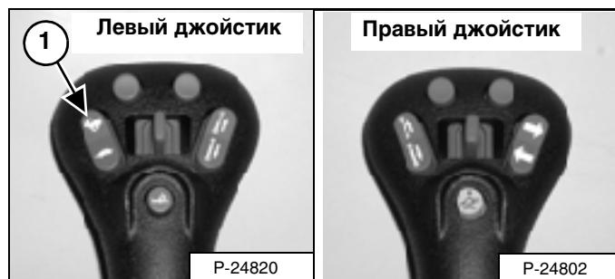
Когда индикатор (1) перестанет мигать, нажмите на верхнюю часть двухпозиционного переключателя скоростей (1) [Рис. 81], чтобы переключиться в двухскоростной режим [Рис. 79].
