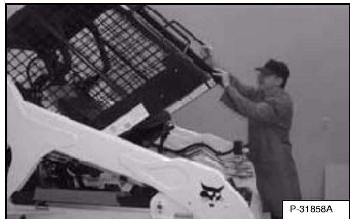
Держась за поручень и низ кабины оператора, медленно поднимайте ее, пока она не займет крайнее верхнее положение, а фиксирующие механизмы не сработают [Рис. 144].
