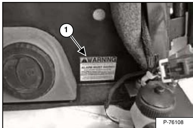
Проверьте наличие и целостность предупреждающей таблички звуковой сигнализации заднего хода (1) [Рис. 139]. При необходимости замените.
