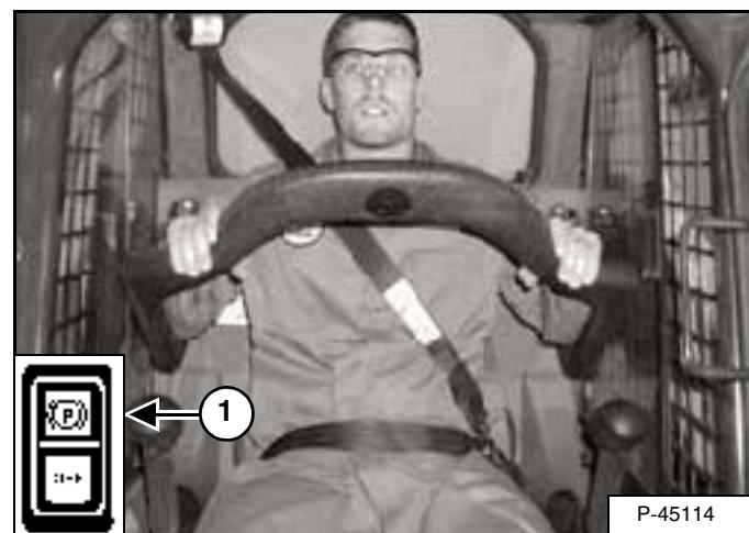
Опустите раму безопасности и включите стояночный тормоз (1) [Рис. 69].
