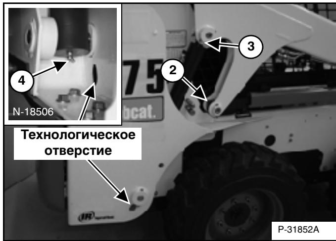
2. Стабилизатор - сзади (с обеих сторон) [Рис. 201].
