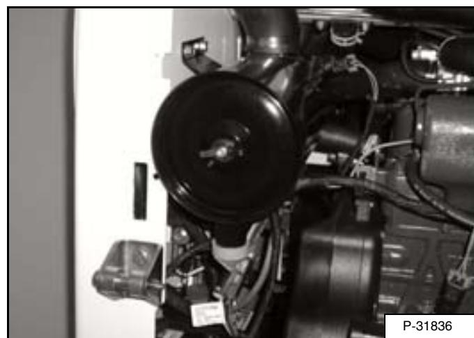
Отвернув барабашковую гайку, снимите пылезащитную крышку [Рис. 158].
