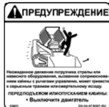
**ПРИМЕЧАНИЕ:** На машинах, оборудованных системой расширенного управления (ACS) рычаги управления движением могут касаться кабины при ее подъеме и опускании. Перед тем как поднять или опустить кабину, ВСЕГДА выключайте двигатель.
