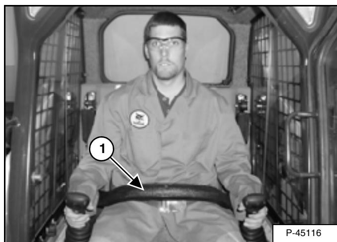
Система блокировки (рама безопасности) состоит из подвижного защитного ограждения сиденья с подлокотниками (1) [Рис. 13].
