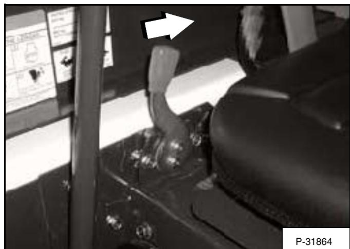
Установите рычаг управления оборотами двигателя в положение холостых оборотов [Рис. 74].
