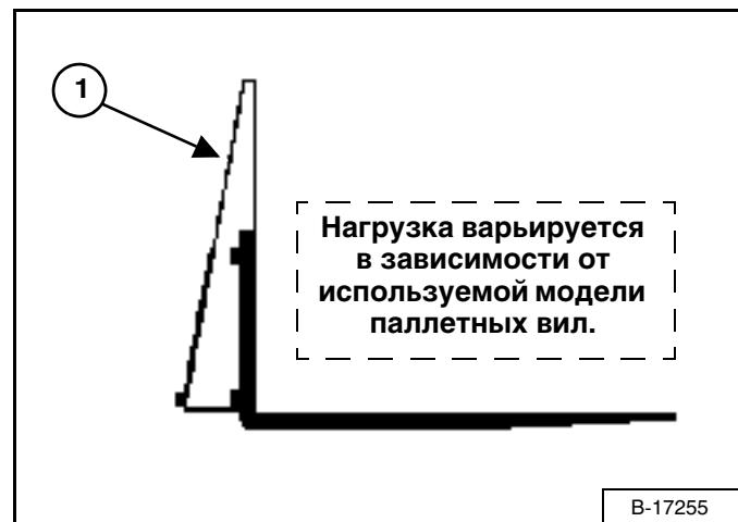
Макс. масса груза, которая может перевозиться при помощи паллетных вил, указана на предупреждающей табличке, расположенной на раме паллетных вил (1) [Рис. 93].
