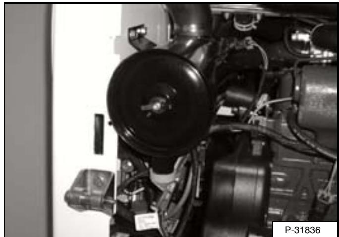
Установите пылезащитную крышку и баращковую гайку [Рис. 161] (убедитесь, что дренаж направлен вниз).
