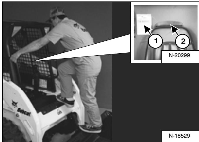
Поднимайтесь в кабину погрузчика и выходите из нее с помощью ступенек на ковше или навесном оборудовании, поручней и подножек (на верхней части стрелы погрузчика и раме) [Рис. 64]. Не выпрыгивайте из кабины.
