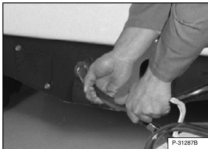
С помощью насоса слейте масло из картера цепной передачи [Рис. 195].
