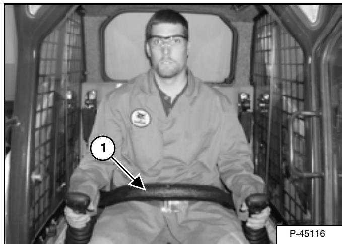
Система блокировки управления Bobcat (BICS) состоит из подвижного защитного ограждения сиденья с подлокотниками (1) [Рис. 14].
