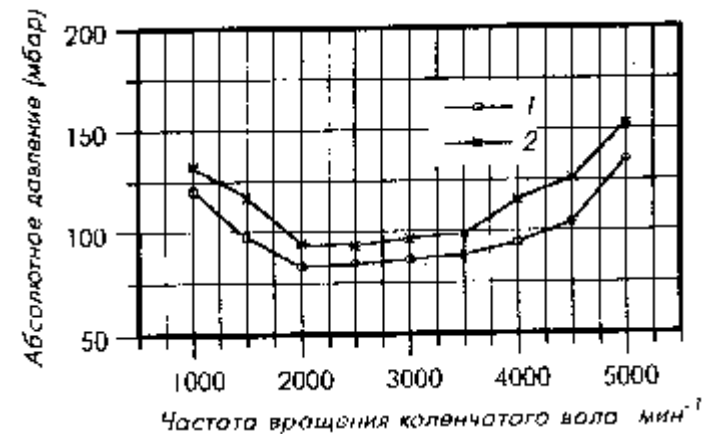
Рис. 3.9.2 Зависимость абсолютного давления во впускной системе от частоты вращения коленчатого вала при загнутой дроссельной заслонке (1 - увеличенный зазор в механизме газораспределения, 2 - нормальный зазор в механизме газораспределения)
