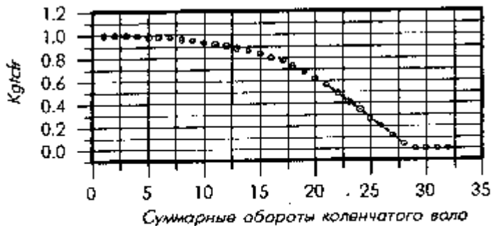
Рис. 4.3.4 Зависимость изменения подачи топлива от количества оборотов коленчатого вала двигателя с начала пуска
